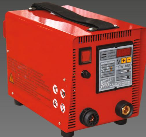
Le système de soudage **TSW 1500 CAR** opère à travers une batterie de condensateurs qui débite la puissance de soudage dans un temps extrêmement rapide (2-3 ms) pour permettre le soudage de pivots de 2÷8 mm.
