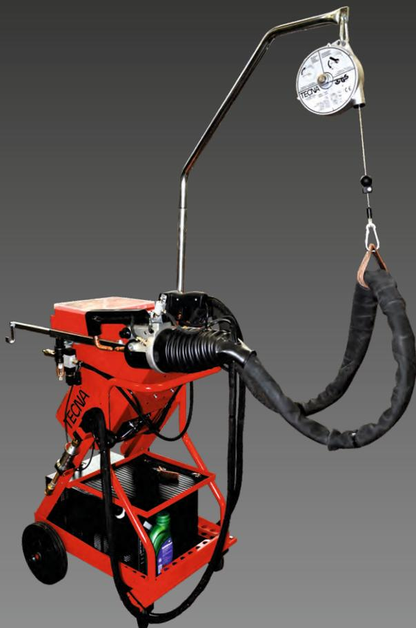
Poste de soudage à courant continu avec technologie à inverter M.F. 25 kVA (1000 Hz) avec double programme, pneumatique, refroidis par eau, connexion simultanée de deux outils avec rappel automatique du programme de soudage mémorisé, qui permet de gagner du temps, éviter des fautes et avoir un travail simple et sûr. Fast gun, pince pneumatique brevetée à course réglable avec gâchette à double action.
