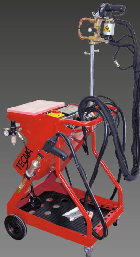
**Poste universel de soudage 10kVA** avec pince pneumatique, avec bras, câbles et électrodes refroidis par eau sur demande, avec double programme pour la connexion simultanée de deux outils avec rappel automatique du programme de soudage mémorisé, qui permet de gagner du temps, éviter des fautes et avoir un travail simple et sûr. Smart gun, pince pneumatique brevetée à course réglable avec gâchette à double action.
