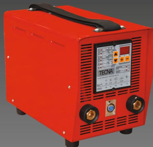
Le **spotter multifonction portable 2250 A** est extrêmement versatile et il est l'équipement idéal pour le redressage des tôles en carrosserie. Les postes de soudage avec transformateurs incorporés sont fournis complets de contrôle de soudage digitale à microprocesseur avec réglage du temps en cycles (de 0,5 à 99) et réglage du courant de soudage. Le poste de soudage est équipé de autostart que l'on peut insérer et vice-versa.
